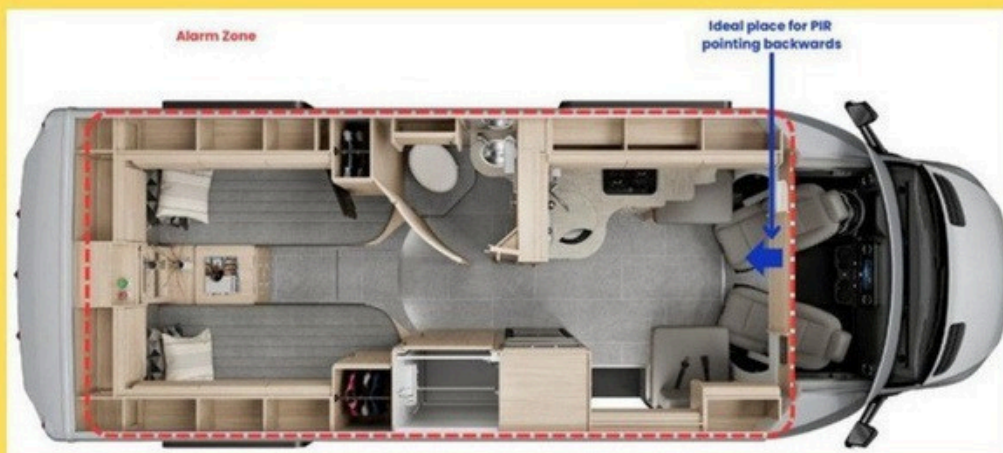
Exempel Larmzon. En typisk installation skulle vara under sängen eller i ett skåp
